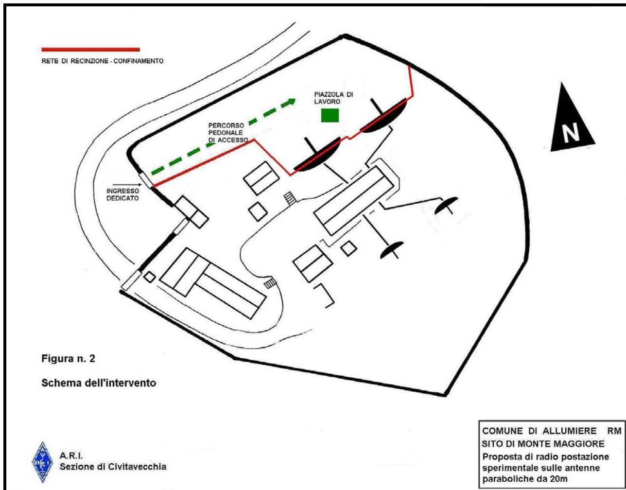
L'accesso avverrà attraverso un cancello secondario, dal quale partirà un camminamento (dovremo provvedere ad una recinzione leggera di separazione dal cantiere) fino alla zona delle antenne.
